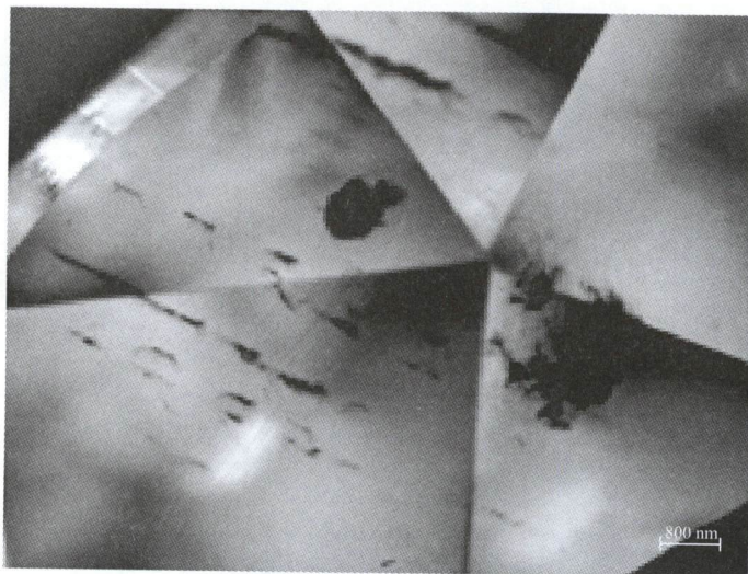
图 C.1 无色 CVD 合成钻石中的不规则深色包裹体
